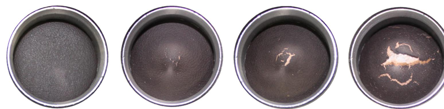
Imagen 3. Imágenes del desempeño de la flor y la aparición del daño. A la izquierda, el inicio de la prueba y al extremo derecho la ruptura del cuero en todo su espesor.
