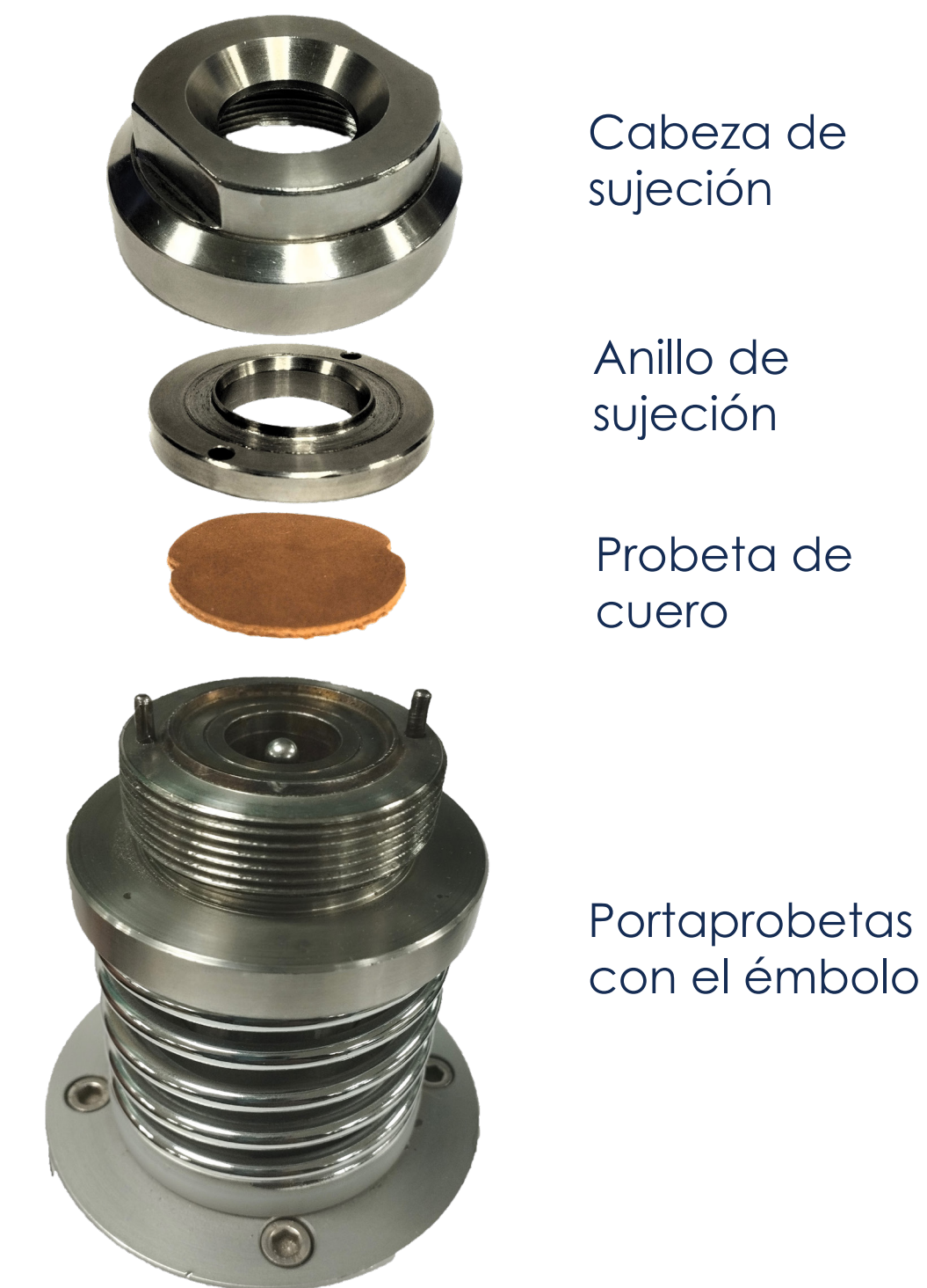
Imagen 5. Piezas de ensamblaje del Lastómetro para la sujeción de la probeta de cuero.
