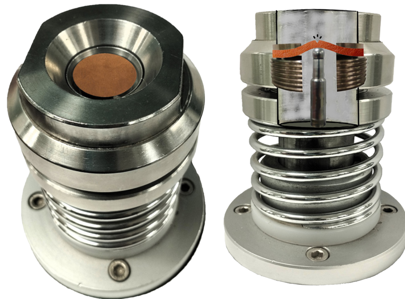
Imagen 6. Lastómetro con la probeta (Izquierda) y visualización de la parte interna (Derecha).
