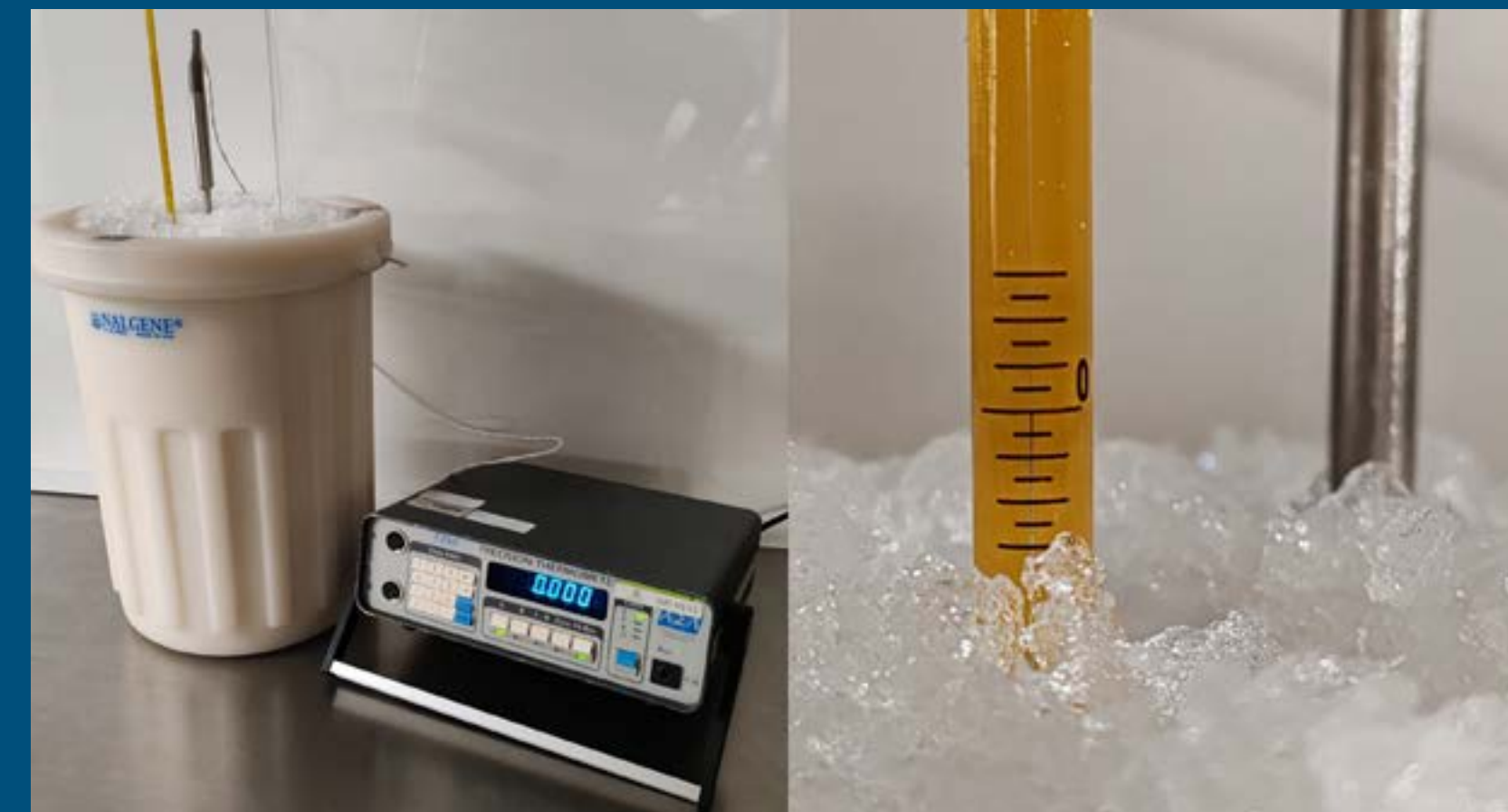
Imagen 4. Sistema de verificación de termómetro de líquido en vidrio. Elaboración propia.
